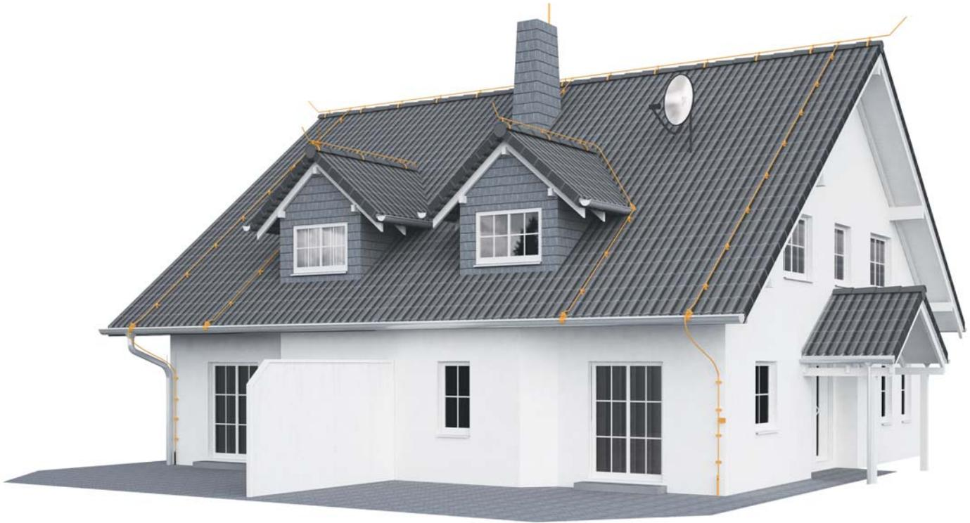
Рис. 2.41: Здание с двухскатной крышей и системой молниезащиты
