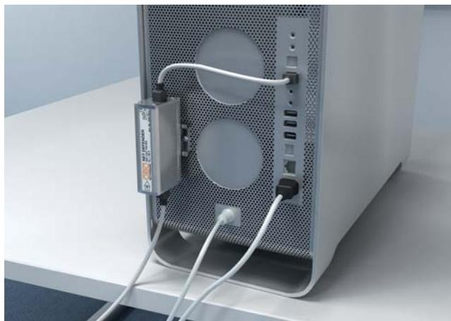
Рис. 3.82 Рекомендация по защите на оконечном устройстве.
