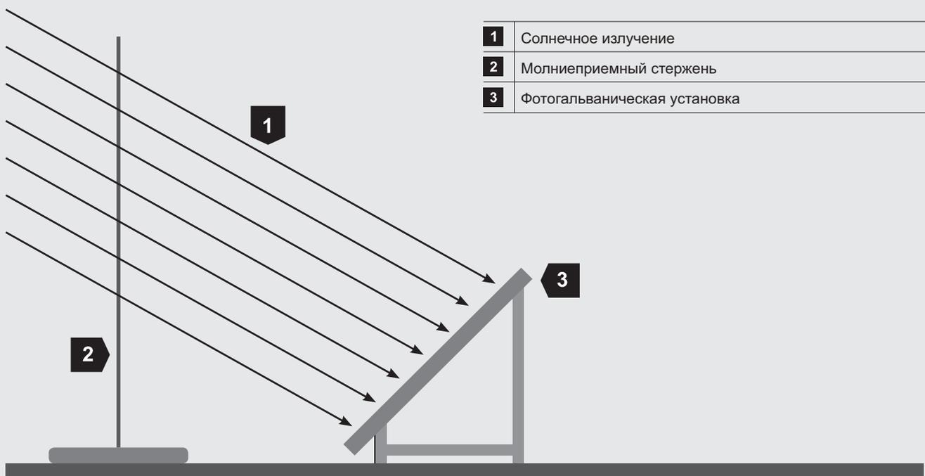
Рис. 3.22: Затенение фотогальванического модуля молниеприемным стержнем
