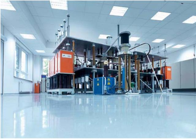
Рис. 1.25: Генератор токов молний центра ВЕТ
