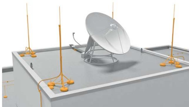
Рис. 2.61: Разделенная молниезащита с молниеприемными стержнями
