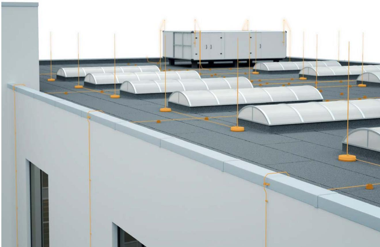
Рис. 2.14: Естественные компоненты (здесь: металлическое ограждение крыши) системы молниезащиты, МЭК 62305-3
