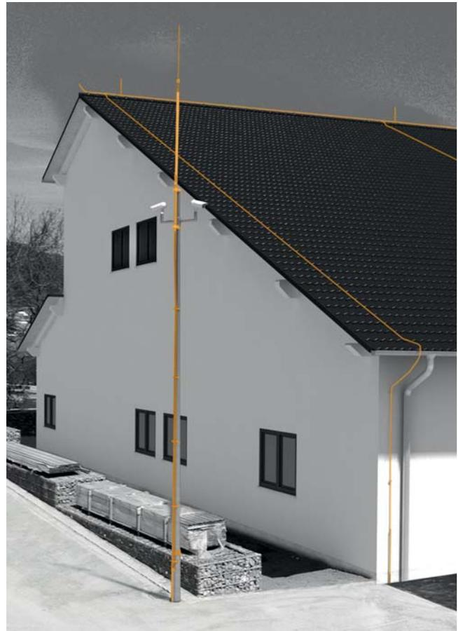
Рис. 2.73: Камера видеонаблюдения с токоотводом isCon®
