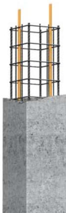
Рис. 2.53: Пример: Использование армированных бетонных опор и токоотвода
